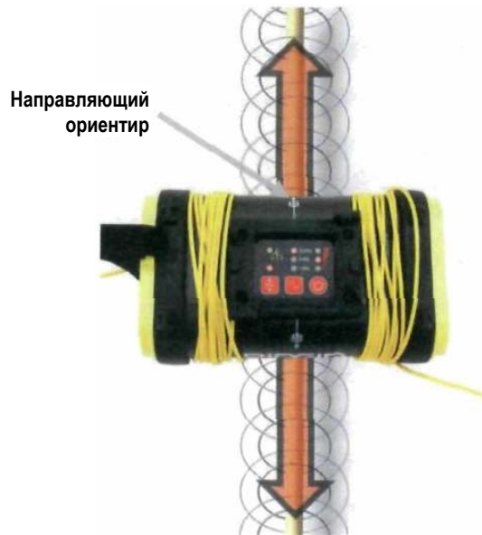
Рисунок 11: Ориентация на линию – Индуктивный метод
