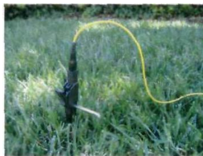
Рисунок 4: Подсоединение ST-305 к заземляющему штырю
